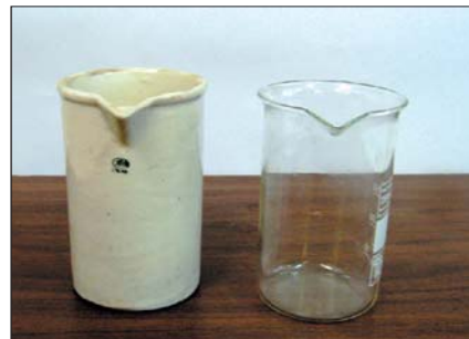
Мал. 13. Однакові стакани виготовлені з різних матеріалів – фарфору та скла
